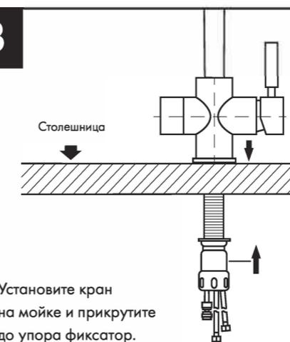
Установите кран на мойке и прикрутите до упора фиксатор. Накрутите на удлинительную трубку для питьевой воды фитинг.
