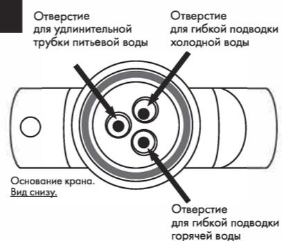
Вверните в основание крана гибкие подводки для холодной и горячей воды и удлинительную трубку для питьевой воды согласно схеме.
