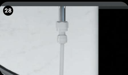
Подключите систему к крану чистой воды. Один конец белой трубы вставьте в фитинг, установленный на кране чистой воды (предварительно снимите стопорную клипсу), затем зафиксируйте трубку стопорной клипсой.
