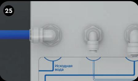
Свободный конец синей трубыки, ранее подключенной к шаровому вентилю, подключите к фитингу насосного блока (Исходная вода) согласно рисунку.
