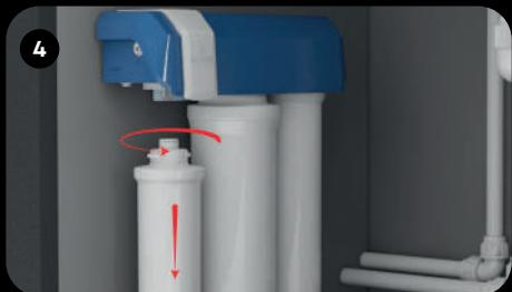
Поверните фильтроэлемент против часовой стрелки и отсоедините его от блока фильтра.
