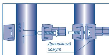
с уплотнением таким образом, чтобы отверстие в сливной трубе совпало с отверстием хомута. Установите вторую скобу и равномерно затяните крепежные болты так, чтобы две скобы располагались параллельно друг другу. Установите один конец ЧЕРНОЙ пластиковой трубы в фитинг дренажного хомута.
