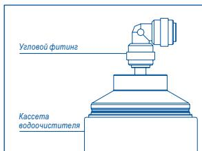
Установите корпус БАРЬЕР Минерализатор RO между тройником постфильтра и автопереключателем пластиковыми трубками. Для соединения пластиковой трубы с фитингом достаточно вставить трубку на 15–17 мм в фитинг.
