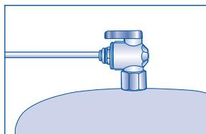
Откройте кран для чистой воды, чтобы сбросить давление, затем закройте кран.
